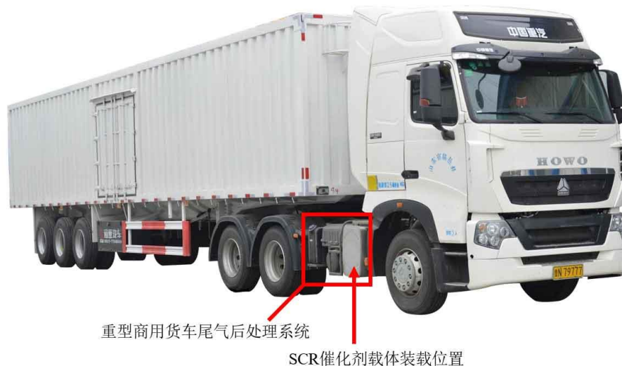
图：柴油重型商用货车尾气后处理系统（国五）与 SCR 载体装载位置示意图
