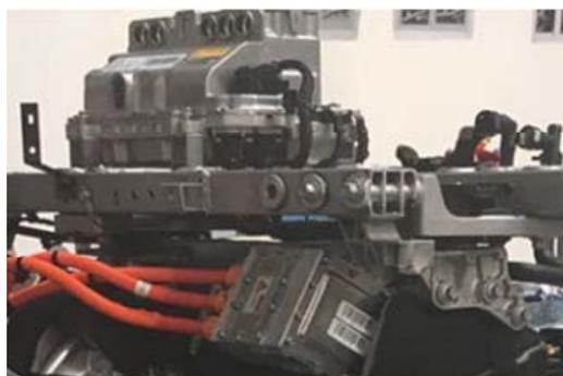
新能源汽车动力总成托架
