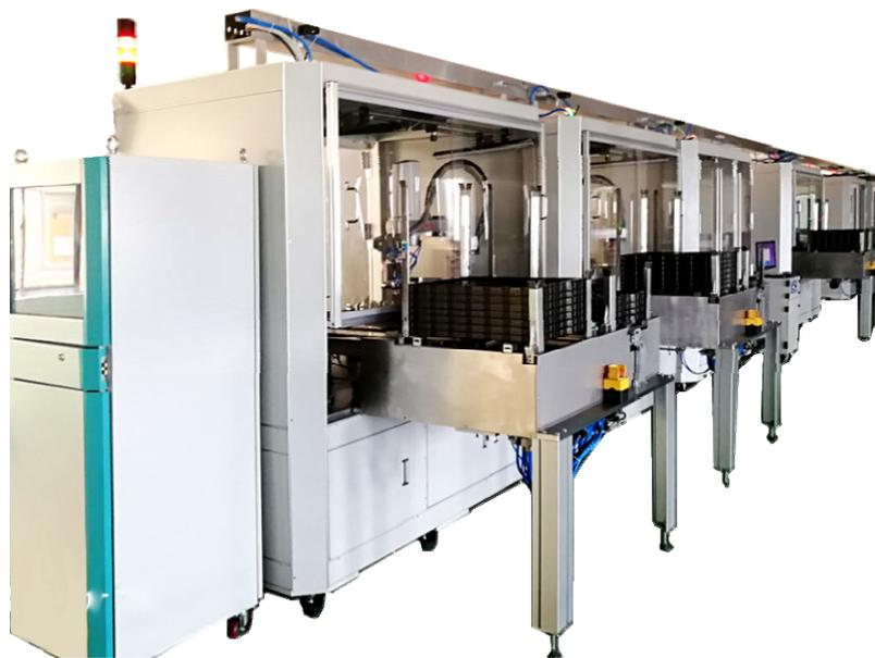
（11）铁壳焊接铆压滑焊自动机
