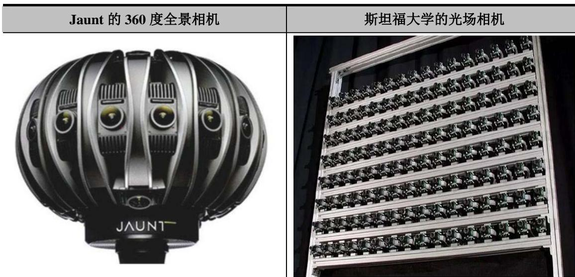
上述 VR 内容制作公司通常采用 360 度无死角的多镜头全景摄像机，将每个镜头得到的影响进行无缝结合，对每个镜头的清晰度、色差等都有要求，对光学镜头提出了更高的要求。
