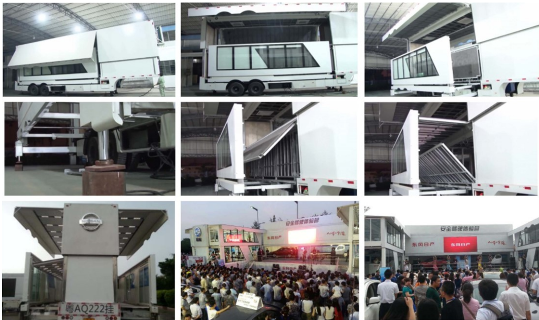
东风日产安全驾驶体验营：使用液压技术实现巡展车一键拆搭
