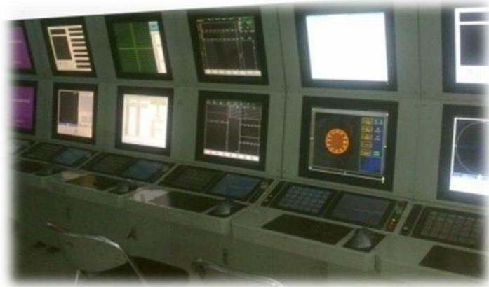
声纳模拟仿真系统由显控台、通用信号处理设备、计算服务器等硬件部分和相应的水声信号模拟软件、声纳显控软件、声纳信号处理软件、对抗系统软件等组成。
