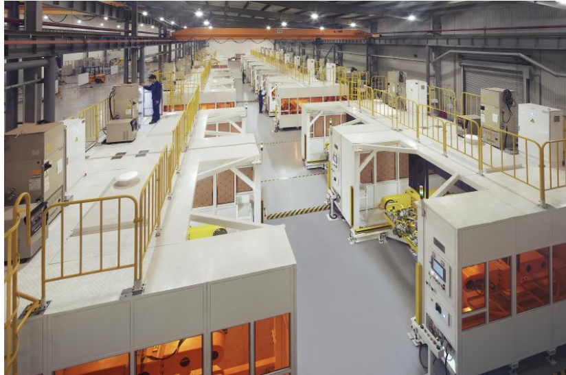
图：发行人建造的摩托车焊接生产线
