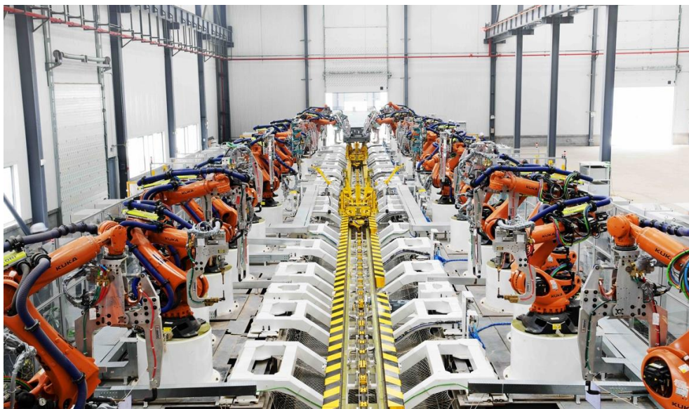
图：发行人建造的地板焊装生产线
