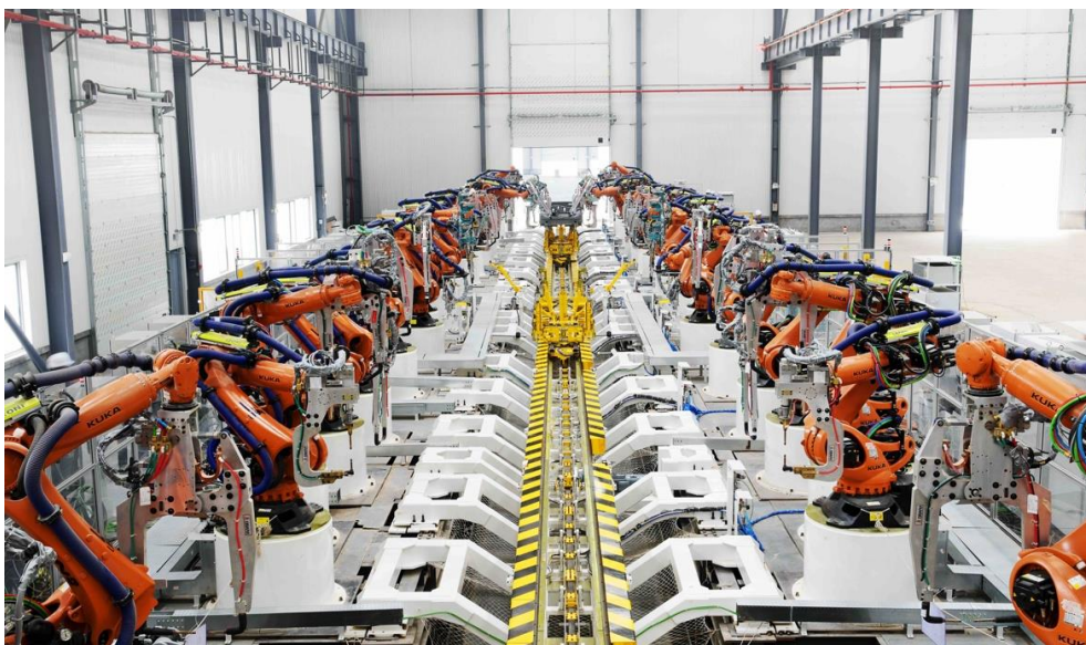
图：发行人建造的地板焊装生产线
