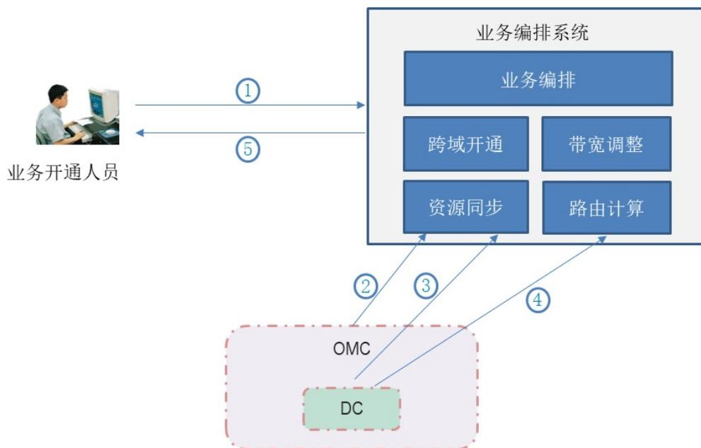
该系统主要工作流程包括：①业务开通人员根据业务要求设计业务；②系统由 OMC（Operation and Maintenance Center 操作维护中心）系统同步资源数据；③系统通过业务编排和路由计算，完成设计方案并进行业务发放；④由 DC（Domain Controller 域控制器）将业务数据实时同步给 OMC，系统由 OMC 同步跟新业务发放后的资源数据；⑤业务发放结果及时反馈给业务开通人员或相关系统。
