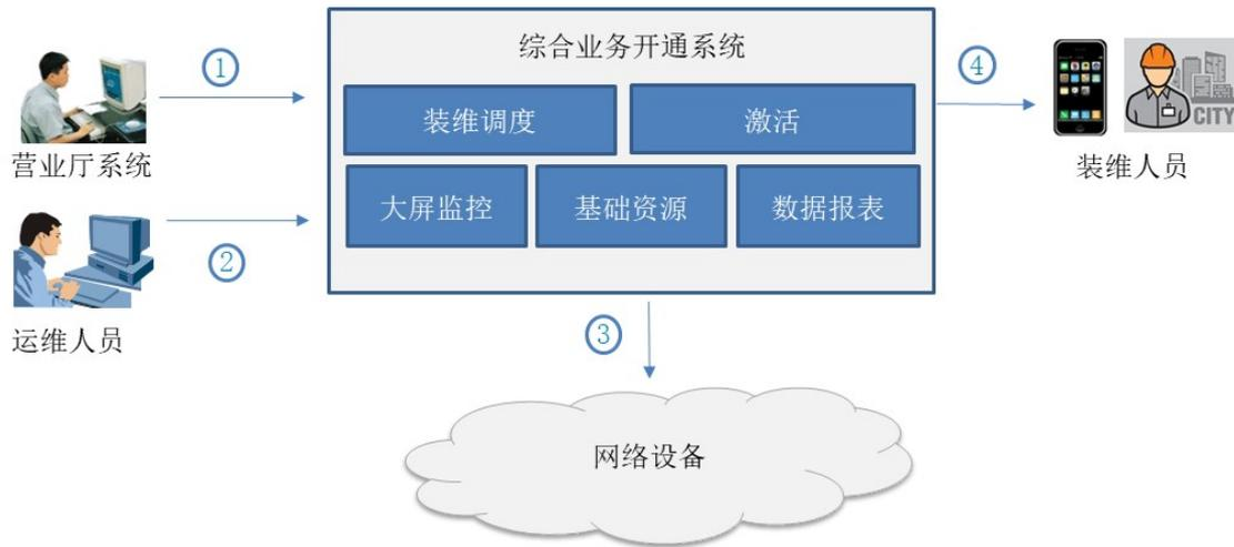
该系统主要工作流程包括：①运营商客户通过营业厅等渠道办理业务，由CRM（订单中心）下发订单到系统；②系统基于流程引擎和实时数据资源，提供一系列管控能力，实现了业务的规范化开通流程；③进行资源的查询和方案设计，并实时反馈；④在施工阶段提供激活能力和掌上环节运维能力，保障专线开通的及时率
