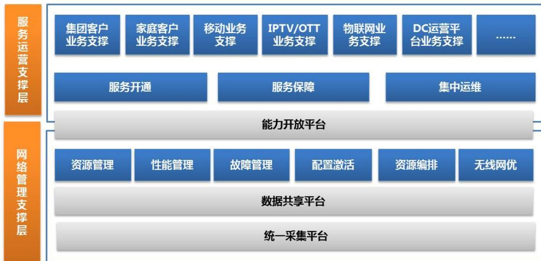
能力开放平台汇聚网络管理支撑系统对网络和设备的管理和控制能力，并将这些底层支撑能力进行编排和封装，以服务方式向上层服务运营支撑系统或其他外部系统（如 MSS 系统和 BSS 系统等）提供能力访问接口，并对平台服务调用的访问权限、访问流量等进行控制。
