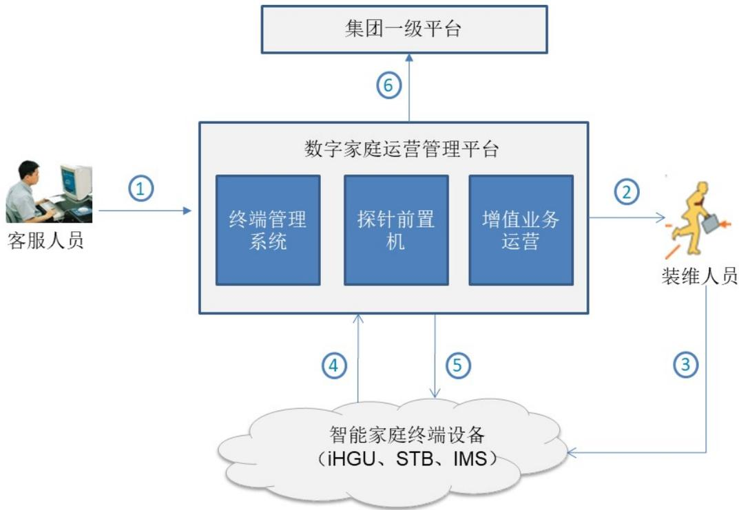
该系统主要工作流程包括：①客服人员受理用户开通家庭宽带业务的申请；②装维人员接收任务工单并安排上门安装；③装维人员上门组网、测试；④新网关加电上线，完成自检、网络激活；⑤平台自动下发用户业务参数，完成业务开通；⑥业务开通信息上报集团一级平台。
