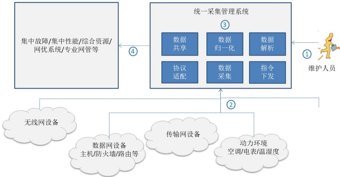
该系统主要工作流程包括：①维护人员录入采集数据源信息及采集策略；②系统根据预先设定的策略采集相关设备的告警、资源、性能等数据；③系统对采集的数据进行解析、归一化，形成统一格式数据；④系统根据共享策略将数据分发到不同的系统供使用。
