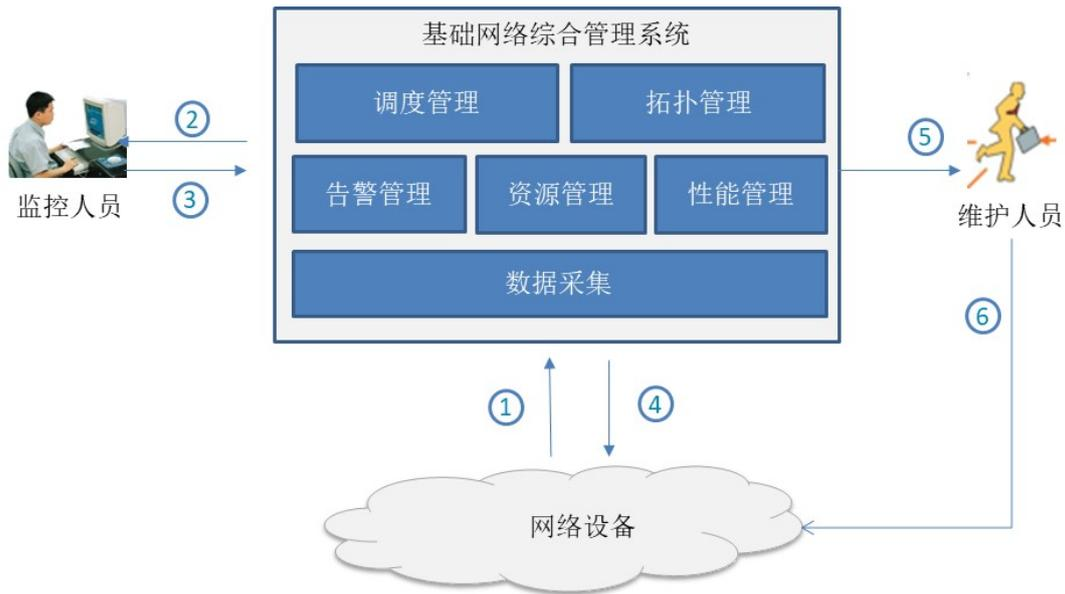
该系统主要工作流程包括：①网络设备数据的收集、统一解析和关联适配（告警、资源、性能等数据）；②监控人员通过系统监控、调度；③监控人员通过系统下发设备操作命令；④系统对设备下发命令；⑤系统自动完成周期性巡检及故障分析；⑥指派维护人员进行设备及网络维护。
