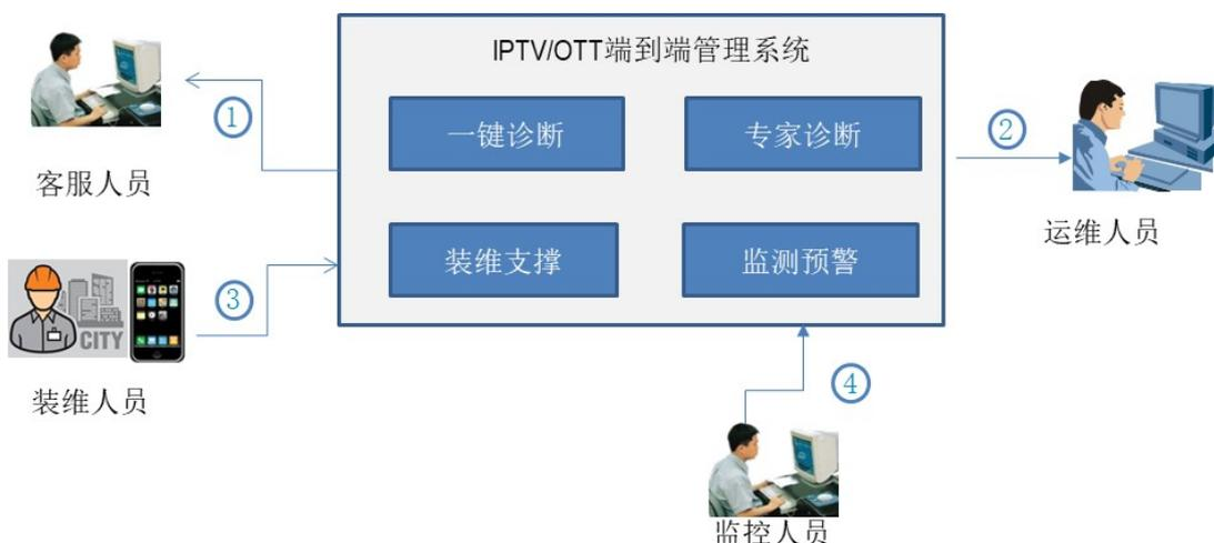
该系统主要工作流程包括：①用户通过电话报障，客服人员调用一键诊断能力实现故障拦截；②对于客服人员无法实现故障拦截的故障，派单到后端运维人员，运维人员调用专家诊断功能实现疑难问题的判断；③对于需要安排上门处理的问题，装维人员在上门处理的过程中，通过装维支撑模块完成故障的现场处理；④监控人员在日常工作中使用监测预警模块对网络和业务质量进行实时监测和预警。
