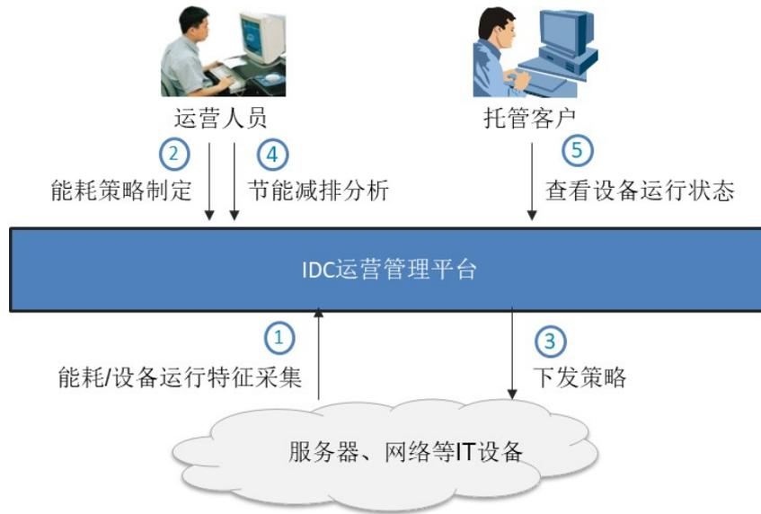
该系统的主要工作流程包括：①系统采集设备的能耗和运行特征数据，获得设备运行的能耗特征和负载特征数据；②根据特征数据制定对应的能耗策略；③将能耗策略下发至设备执行，并动态调整策略；④运营商运营人员进行节能效果分析和能耗策略调整；⑤托管客户可查看托管设备的运行状态数据。
