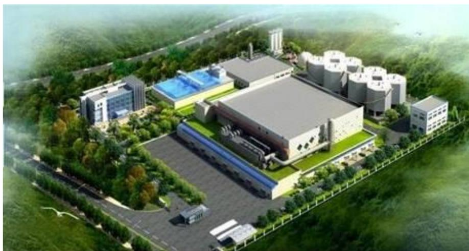
该项目为广州市厨余垃圾处理的大型工程项目，采用 BOT 特许经营方式建设，项目总投资约 4.1 亿元，运营期 28 年（含建设期 2 年）。主要建设内容包括预处理系统、厌氧发酵系统、臭气处理系统、废水处理系统、沼渣污泥处理系统、
