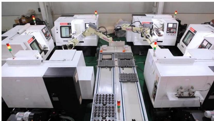
汽车球壳自动化生产线
