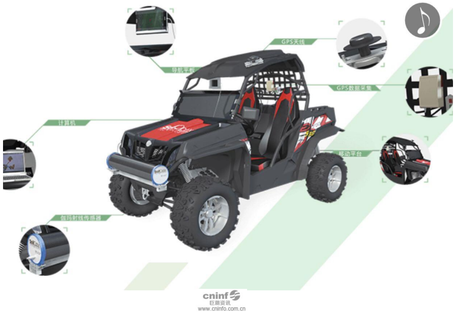
图：应用SoilOptix等多种数字技术开发的CT土壤检测车
