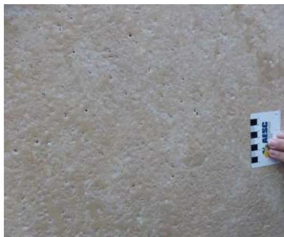
圖8-5：黃色板料革面顯示小空隙的成品效果
