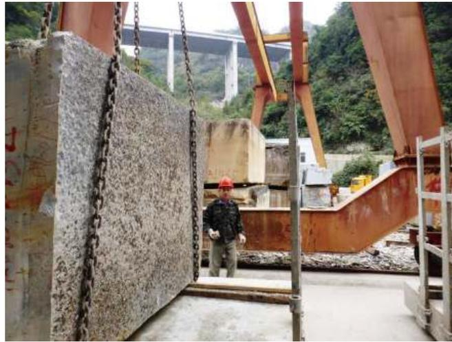
圖8-1：龍門吊運送石塊，裝載排鋸，背景為石塊堆場
