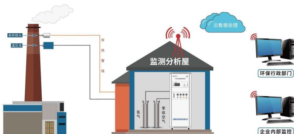
VOCs 在线监测系统工作示意图
