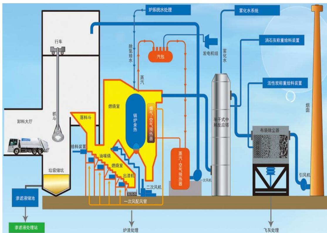
生活垃圾焚烧发电工艺主要包括以下各环节：（1）垃圾接收、储存与输送系统；（2）垃圾焚烧系统；（3）余热利用和发电系统；（4）烟气净化系统；（5）自动控制系统。
