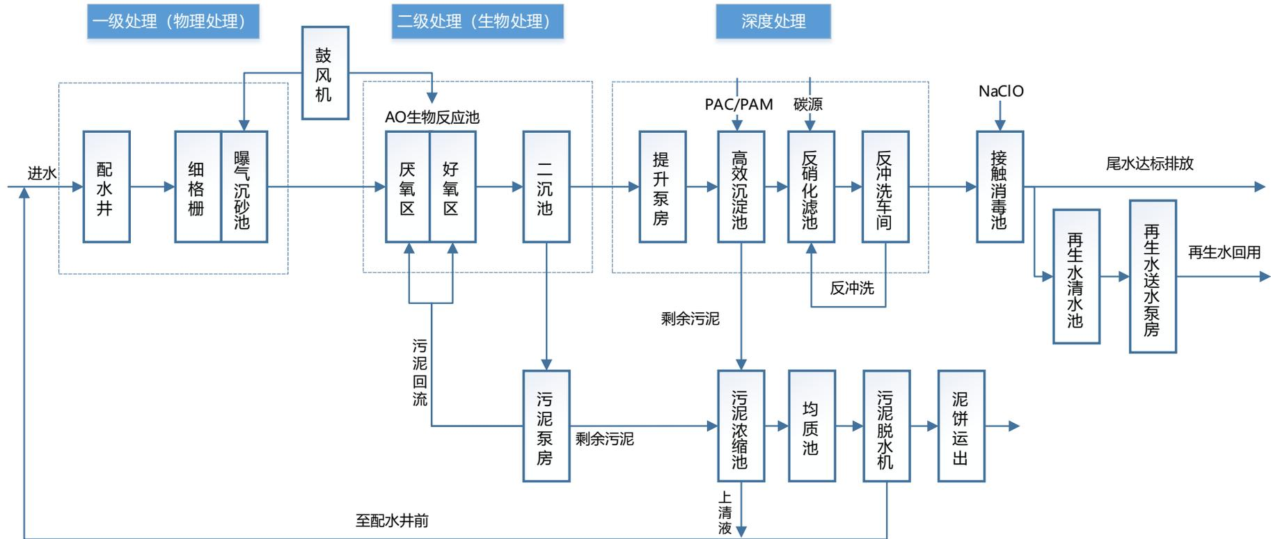
泉州圣泽拥有的北峰项目采用 CAST 工艺及深度处理，工艺流程图如下图所示：
