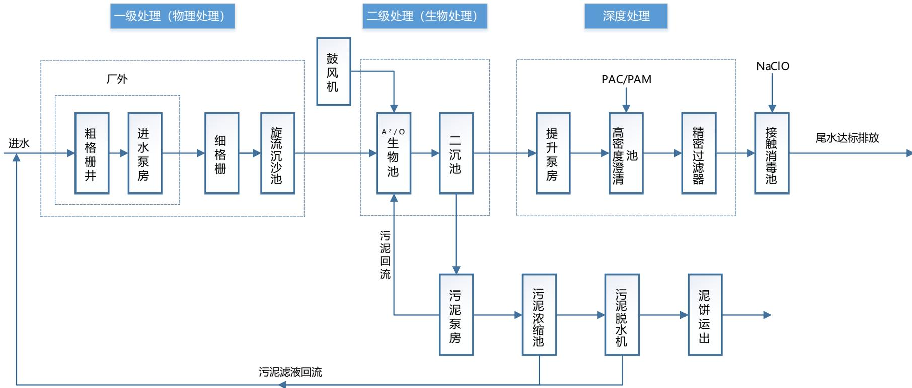
龙海水务一期采用改良型卡式氧化沟工艺及深度处理，工艺流程图如下图所示：
