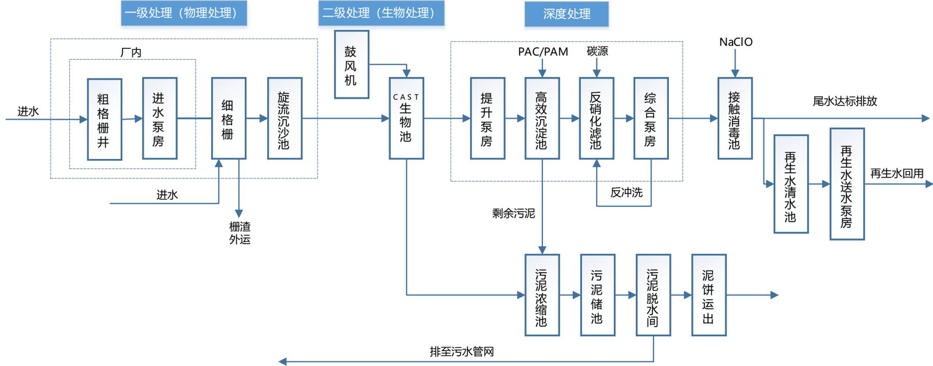
安溪安晟拥有的安溪安晟一期、二期和漳浦旧镇一期采用 A<sup>2</sup>/O 工艺，另外安溪安晟一期、二期配备深度处理系统，工艺流程图如下图所示：
