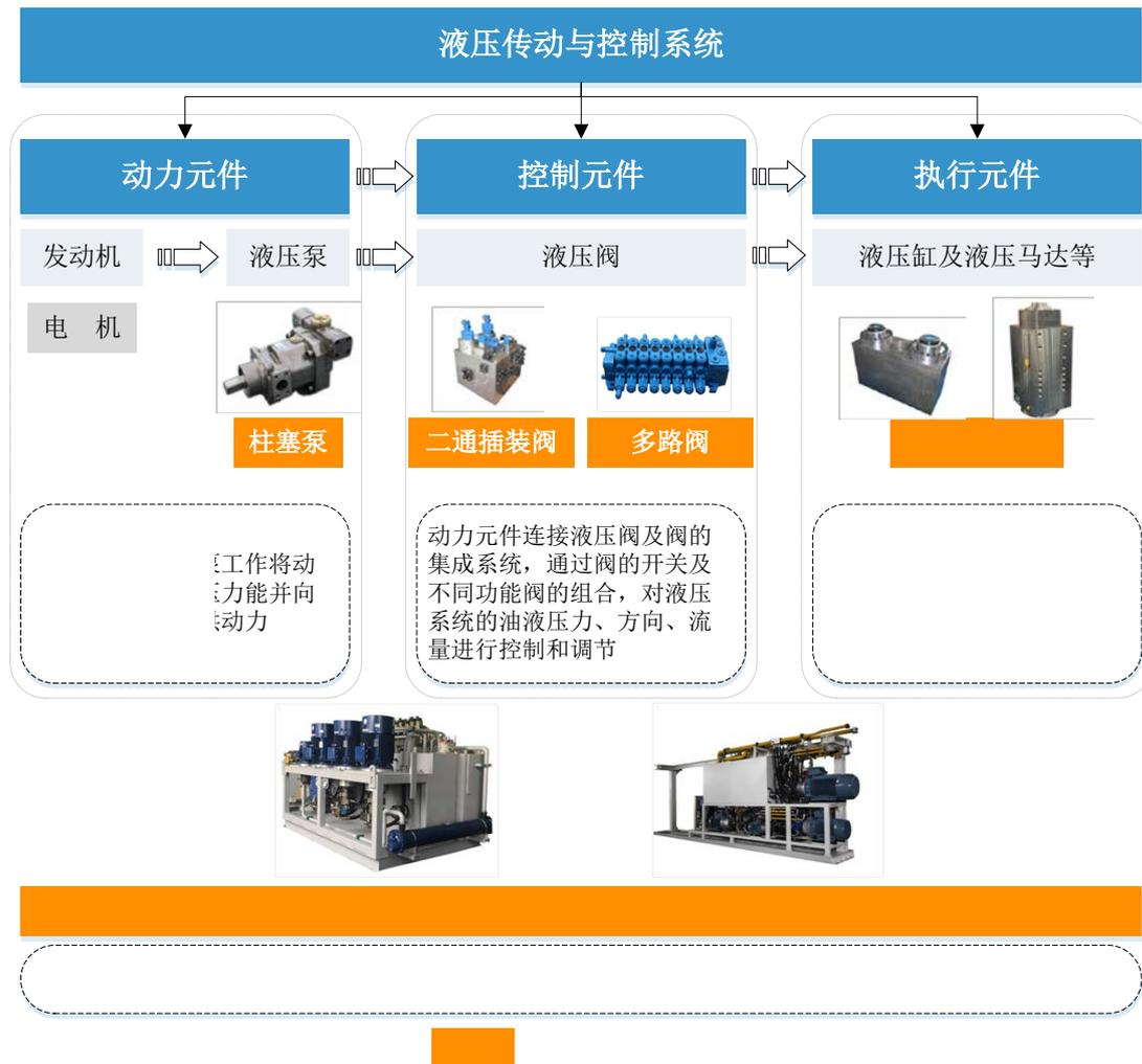
液压传动与控制系统由具备各种功能的机械基础元件组成，以液压油为工作介质，实现各种机械传动和自动控制的功能，主要组成包括：动力元件（主要是液压泵）、控制元件（主要是液压阀）、执行元件（主要是液压缸、液压马达）、辅助元件（主要是油箱）、工作介质（主要是液压油）等 5 个部分，其中阀、泵、缸的技术难度较大、产品附加值较高，是液压传动与控制系统的核心元件。
