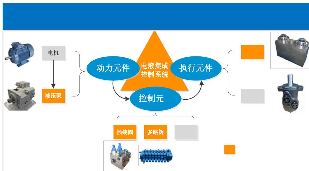
公司电液集成控制系统产品主要为铸锻行业、冶金行业、农业机械和机床行业主机提供完整配套的液压系统整体解决方案。公司电液集成控制系统典型产品如下图所示：
