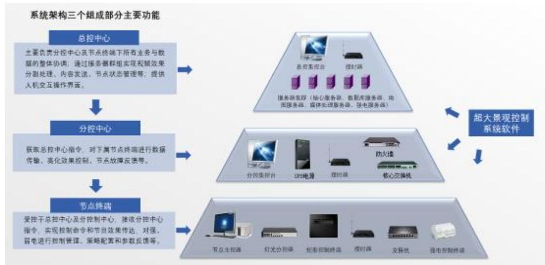
总控中心通过网络将数据发送至区域分控中心，分控中心将数据存储备份后分发至节点终端，同时搜集各节点工作状态，并反馈至总控中心，节点终端主控制器接收数据后，分发至与灯具连接的控制器，最终实现灯光效果。
