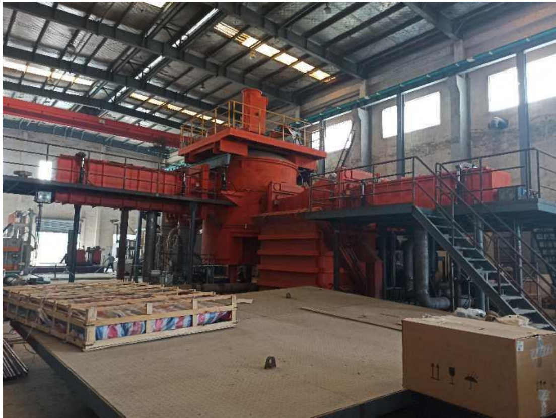
图. 江苏新中洲新购置的 3 吨真空熔炼炉
