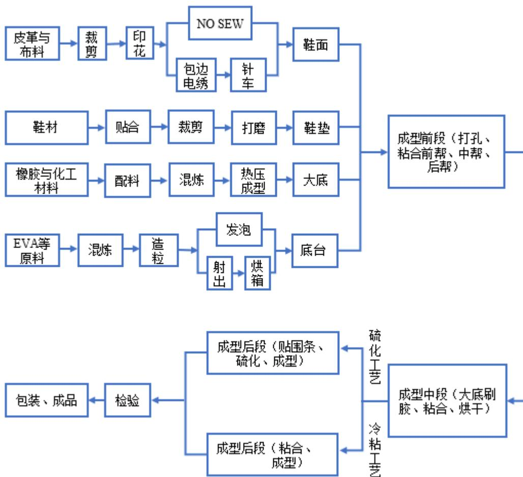
公司主要产品从生产工艺技术上看，按鞋底和鞋面衔接方式的不同，分为冷粘工艺与硫化工艺，相应生产出来的产品为冷粘鞋与硫化鞋。硫化工艺以加硫方式衔接鞋底和鞋面，冷粘工艺以粘合剂衔接鞋底和鞋面，除此之外，其他生产工艺流程大致相同。
