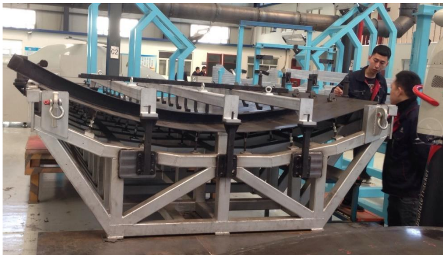
图：CR929 机型预研的货舱门成型工装和试验件产品
