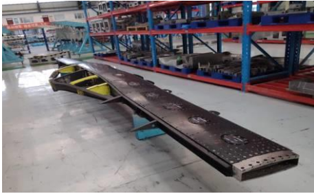
无人机复合材料中央翼部段
