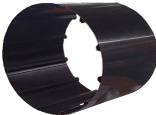
图：CR929 机身筒段试验件
