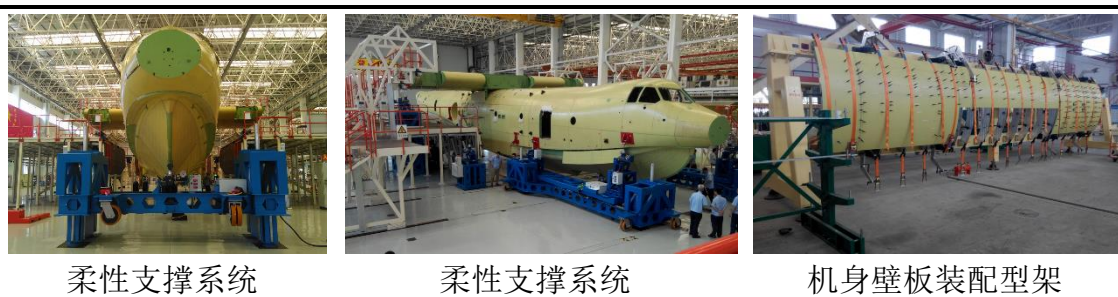
图：AG600 飞机总装配生产线和部分装配型架
