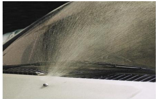
清洗系统工作示意图（前风窗）
