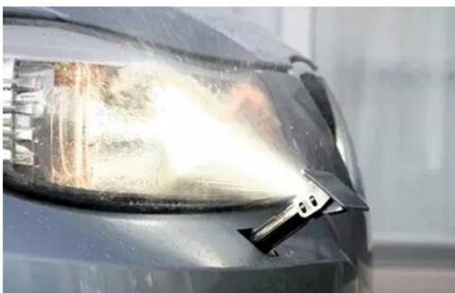
清洗系统工作示意图（车大灯）
