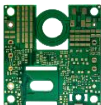
14 层厚铜板/光伏逆变器
