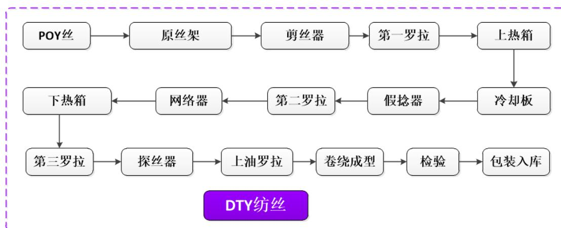
公司 DTY 系列产品主要以自产的 POY 为原料，在加弹机上进行拉伸、经假捻器变形加工后形成的成品丝。公司具备在加弹、假捻过程中的温度、湿度及其他工艺技术参数进行优化设计能力，不断通过技术创新、引进先进生产设备及优化管理模式来确保产品主要技术指标达到优异水平。
