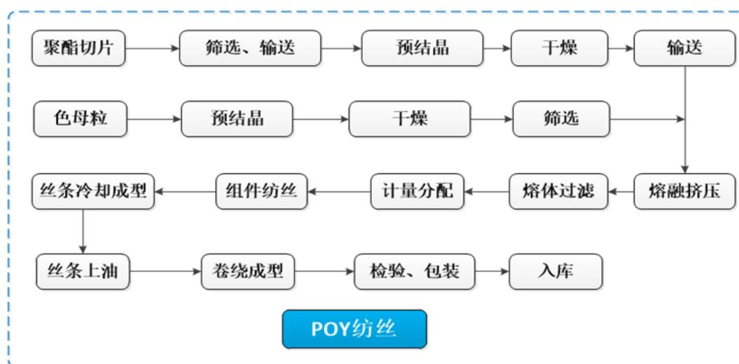
公司生产的 POY 主要为进一步加工 DTY 而准备，少量 POY 直接销售予客户。公司采用专利异形喷丝板结构设计，可以根据用户需求以及产品性能，采用不同异形截面（如三叶、五叶等），因为喷丝板是化纤纺丝部件上的一个重要基础精密零件，纺丝熔体通过喷丝板的微孔喷挤出具有一定粗细和质地均匀的纤维束，喷丝板结构设计和微孔加工工艺是保证纤维成品质量和良好纺丝工艺的重要条件。
