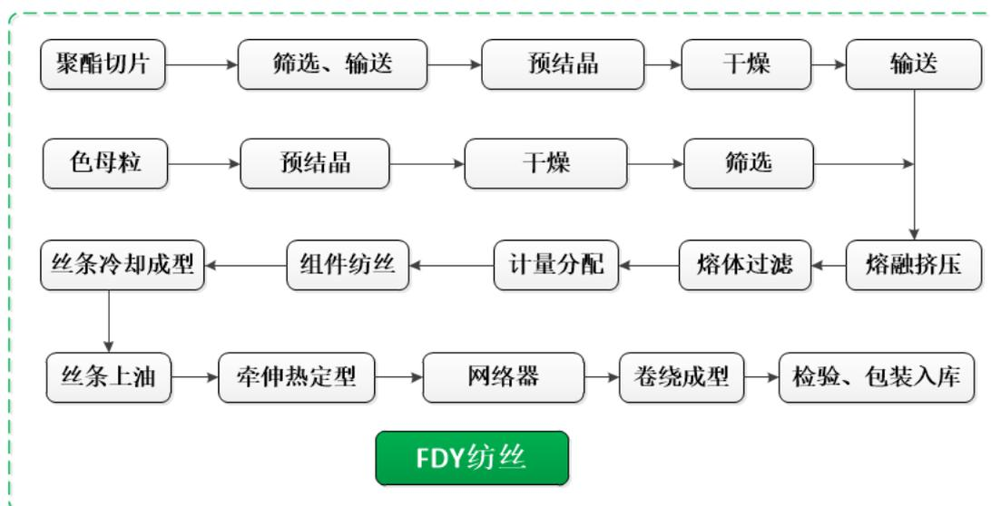
公司经过多年的研发，掌握了 FDY 系列产品生产中有关提高挤压机控制参数、凝固点控制的关键技术，以控制纺丝速度、牵伸和卷绕等工艺技术参数方面的核心工艺。通过工艺改进与创新，改善涤纶丝 FDY 的平滑性、耐热性和抗静电性，也提高了单丝的柔软性和悬垂性以及纤度、色泽的均匀稳定性。
