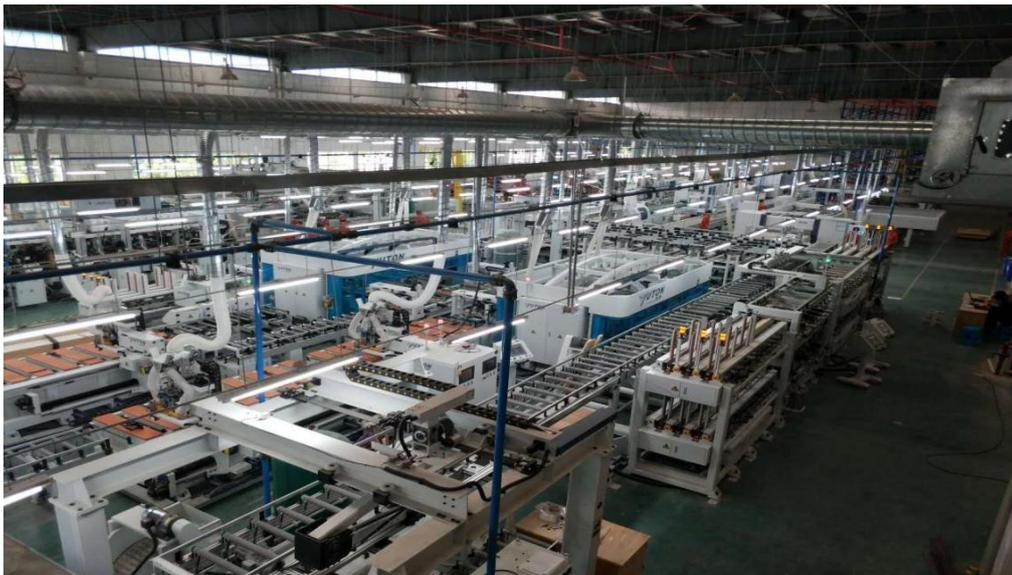
门套自动加工复合生产线现场图
