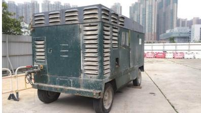
空氣壓縮機主要用於在鑿岩過程從樁孔中移除挖掘物料，方法為利用空氣壓縮抬起挖掘物料
