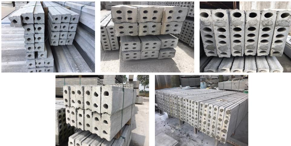
目標集團可就預製混凝土牆板的規格作出以下方面的改動，包括：(a)長度；(b)標準牆板的形狀 (L形及T形)；(c)附有／並無拉力鋼絲；(d)附有／並無 (穿過空心孔洞的) 鋼筋；(e)附有／並無防水特性；及(f)空心孔洞的直徑及數量，從而滿足客戶對以下方面的特定需要及功能要求：
