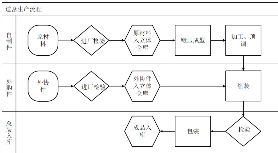
以下为公司轨道交通设备板块弹条扣件、闸片及闸瓦产品的主要生产流程：
