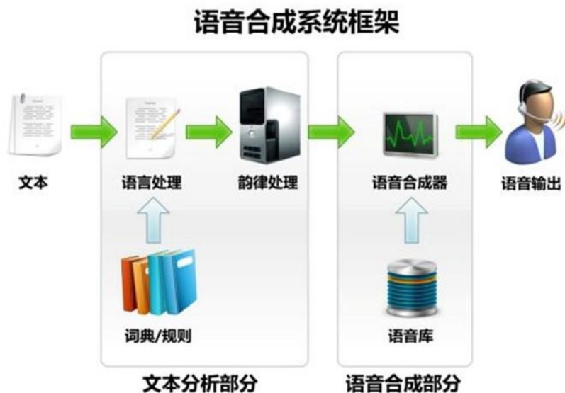
图：语音合成系统框架示意
