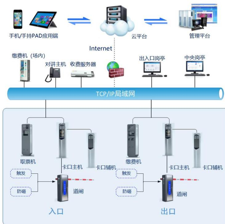
视频免取卡收费系统通常配置摄像机、道闸、收费显示屏、收费服务器、地感线圈或 3D 防砸车检、监控终端等设备或装置。根据停车场特点及客户需求，发行人可以提供不同配置和多种备选功能的视频免取卡收费系统，如可以选择双摄像机配置或单摄像机配置（上图为双摄像机配置，即进出口分别配置两个摄像机），可以选择卡口专用高速摄像机或者卡口专用高速摄像一体机（上图为卡口专用高速摄像机）。
