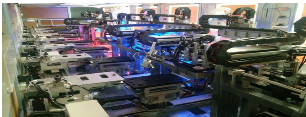
图 2：液晶显示屏防尘屏蔽带贴装线
