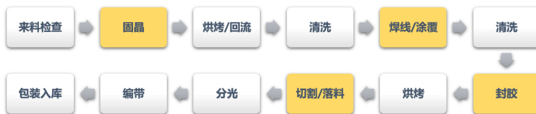
(2) CHIP 型 SMD 封装器件工艺流程图
