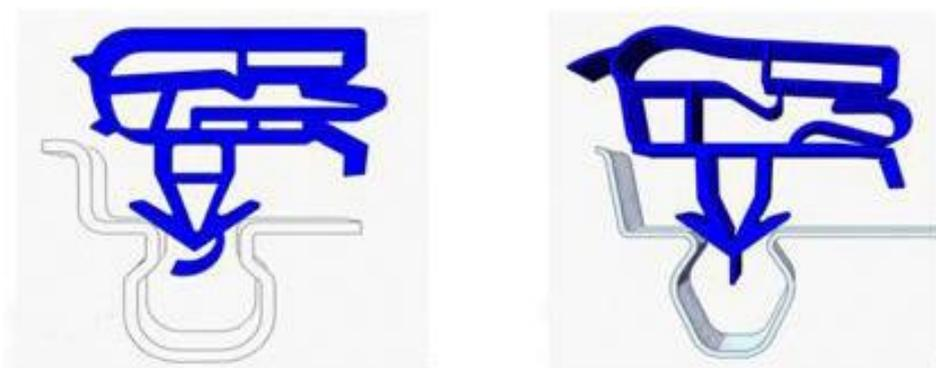
冰箱门封胶套有数个气囊构成，气囊内部空气存在自然对流热换，气囊结构主要增加门封的传热热阻，因此气囊设计是冰箱门封的核心，对冰箱门封的密封、隔热、节能效果起到关键作用。随着对冰箱节能降耗要求的不断提升，公司不断改进胶套气囊设计，并自主开发门封胶套挤出模具。由于胶套质软，为保证一次成型提高焊接效率和成品率，公司通过不断研发积累，现已掌握成熟的门封胶套焊接技术，并研发出自动化四角焊接设备，可实现从一次“单角焊接”到“双角焊接”再到“四角焊接”的工艺升级，焊接效率不断提升。
