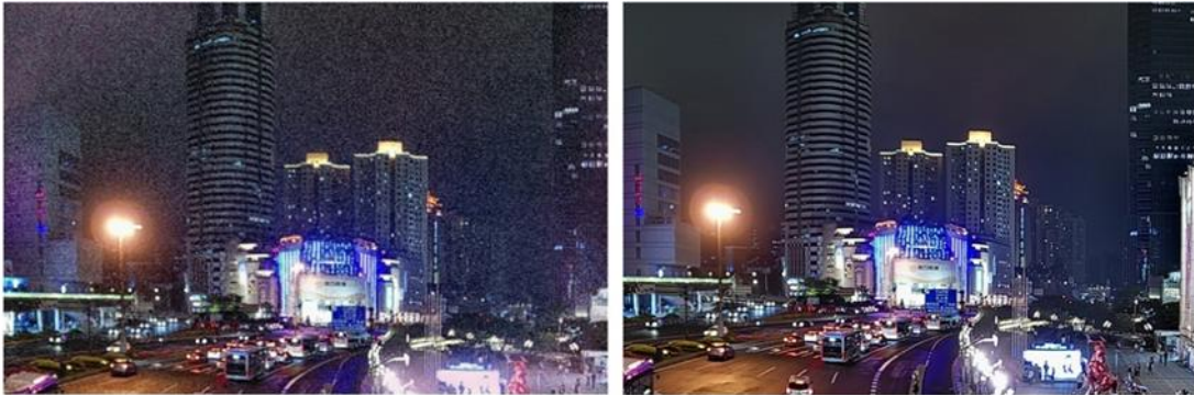
无暗电流优化的图像传感器高温下性能较差
