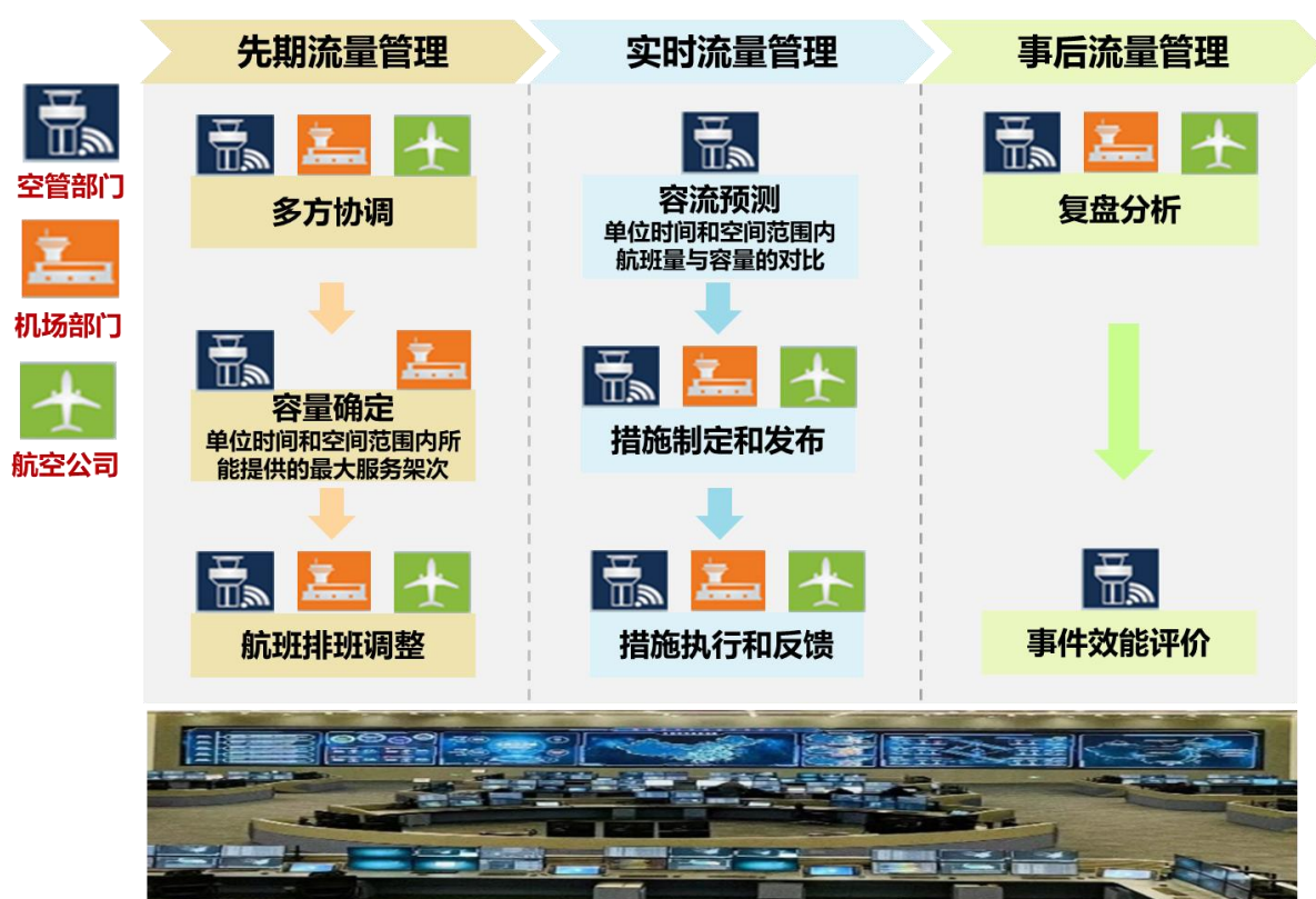
图：流量管理类系统的运行示意图
