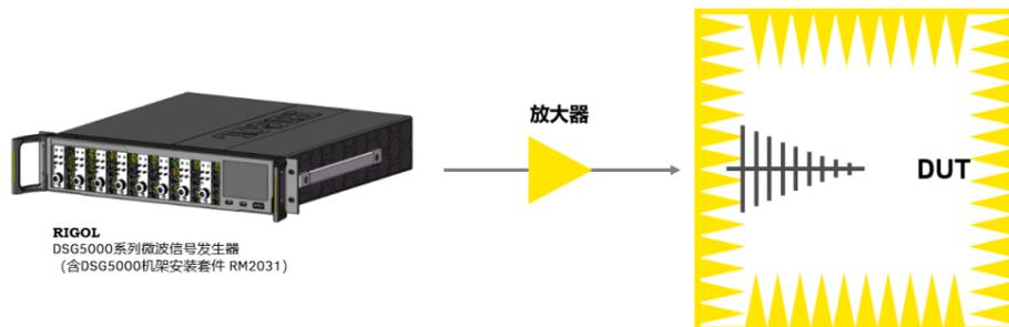
5、微波器件测试。在无线通信系统中，为了实现优异的频谱效率，频率信道的间隔非常小。狭窄的频率信道间隔和宽带通信系统都要求对多余和非线性的频谱失真进行严格测试。失真产物可能是信道内、频段内和频段外出现的多余频谱信号。失真不仅会降低发射机的性能，还会对其他接收机造成干扰。通过对器件的谐波失真和互调失真测试，提升系统性能。
