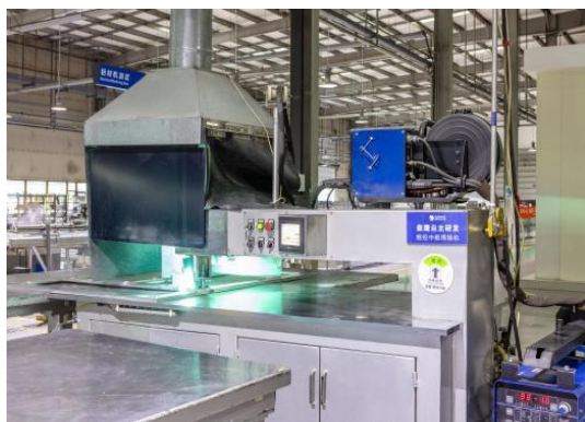
外铝板框数控自动氩弧焊接机
