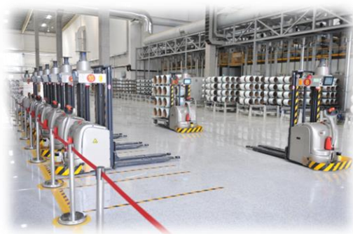
AGV 搬运系统
