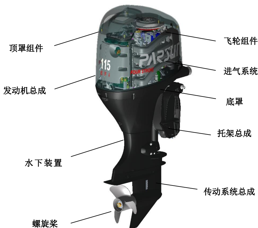
公司 115 马力舷外机产品结构图示
