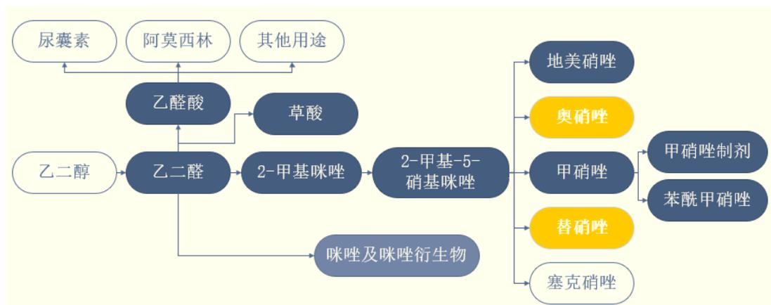
注：图中箭头表示主要产品的生产路线；深蓝色框内的产品为公司现有产品，橘黄色框内产品为公司正在研发的产品；浅蓝色框内产品为正在投建的产品；白色框内的产品为产业链条中的上下游产品。
