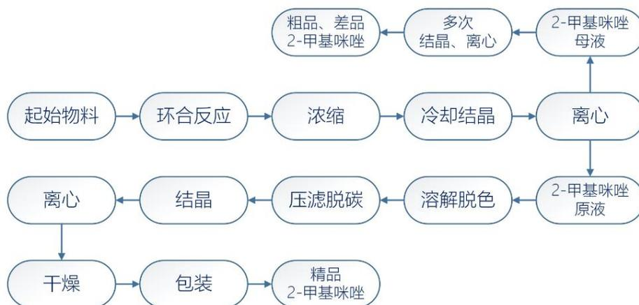
(2) 第二步，2-甲基-5-硝基咪唑生产流程
