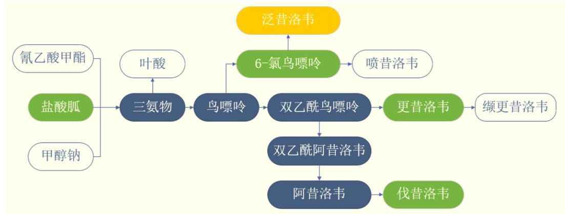
注：图中箭头表示主要产品的生产路线；深蓝色框内的产品为公司现有产品；橘黄色框内产品为公司正在研发的产品；绿色框内产品为拟投建产品；白色框内的产品为产业链条中的上下游产品。
