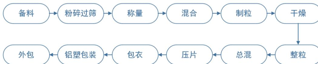
(2) 磷酸西格列汀片和替硝唑片均采用干法压片工艺，生产工艺流程如下图所示：
