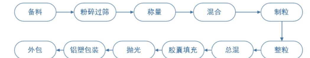
(4) 塞来昔布胶囊、人工牛黄甲硝唑胶囊采用湿法胶囊制剂工艺，生产工艺流程如下图所示：
