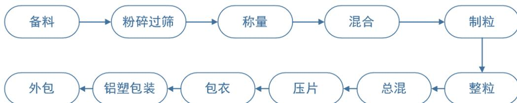
(3) 阿奇霉素胶囊采用干法胶囊制剂工艺，生产工艺流程如下图所示：
