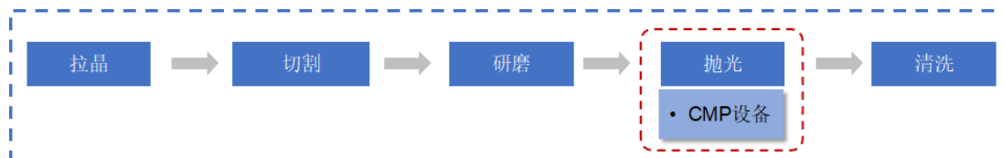
图：晶圆材料制造环节示意图
