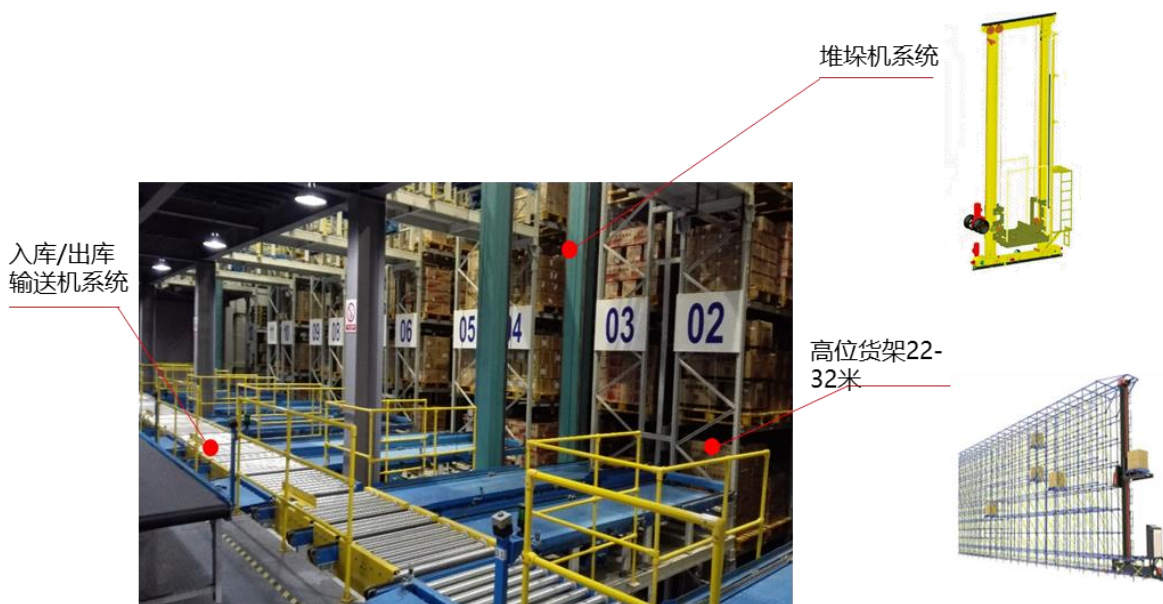
图2-16 自动仓储系统存取系统构成示意图
