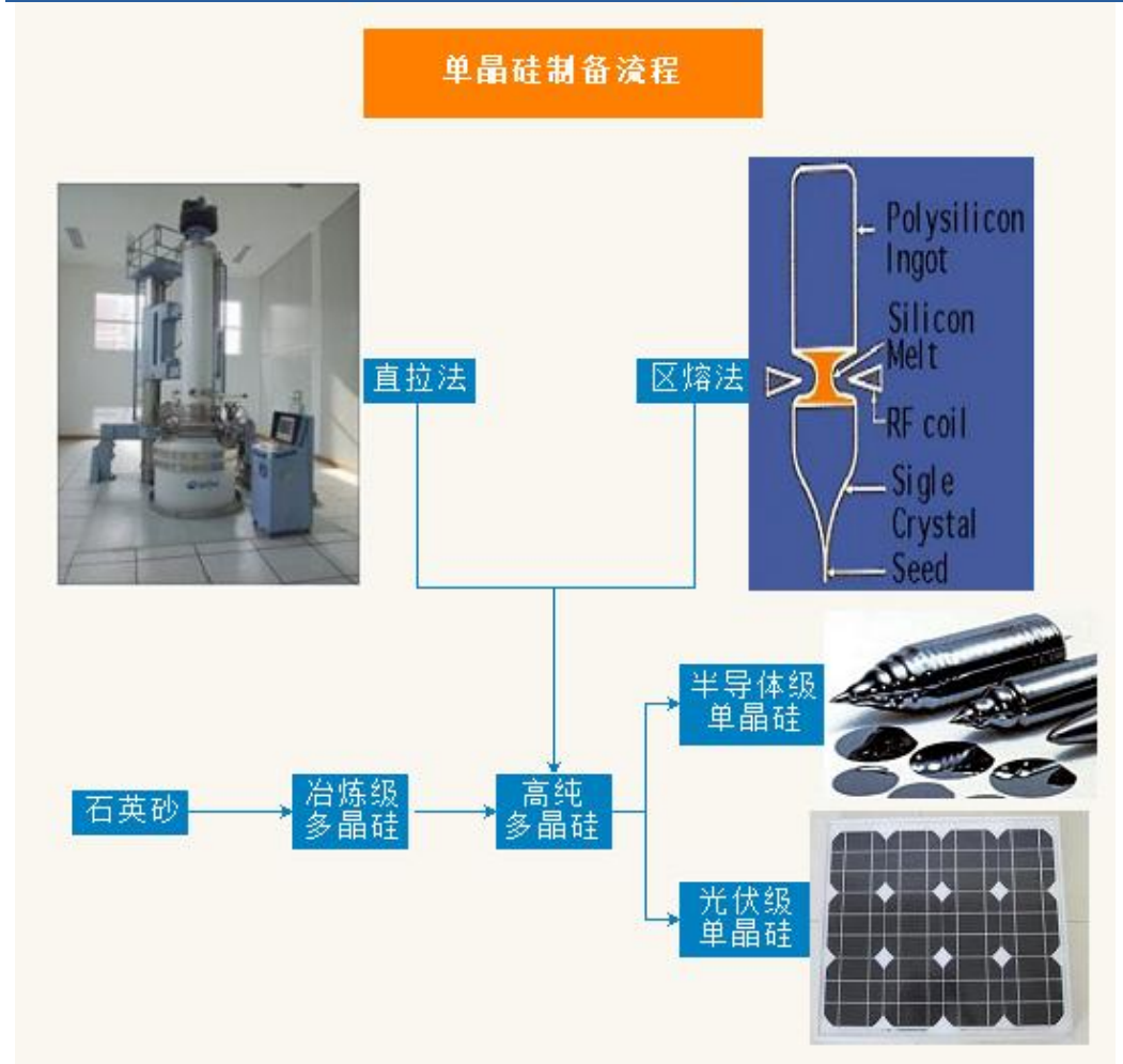
图 10：单晶硅制备流程
