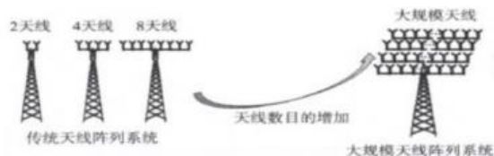
Massive MIMO 示意图：单基站天线阵列增加
