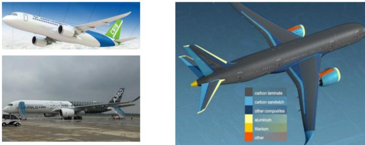
图：C919客机机身结构图
