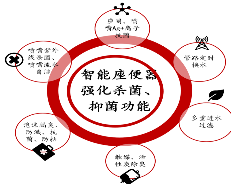
图：智能马桶各种强化杀菌、抑菌手段
