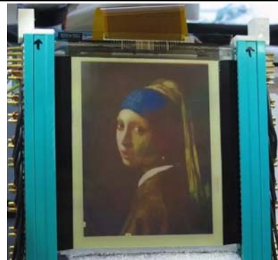
图 34：2013 年理光基于电致变色技术的 3.5 英寸全彩电子纸
