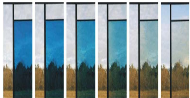
图 22: 电致变色玻璃随着调整对光线的投射逐渐发生变化
