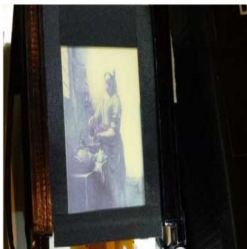
图 33：2011 年理光 64 灰阶全彩显示的电致变色显示器
