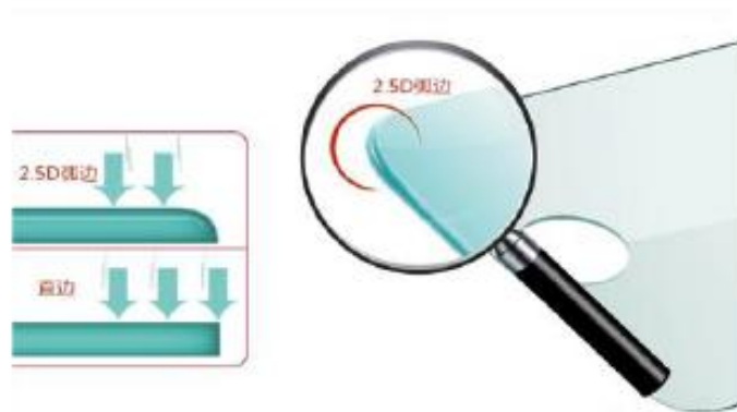
图7：2.5D盖板玻璃在边缘有弧边，能够有效改善用户体验
