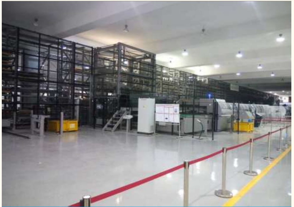
图表 31：华仪电气钣金柔性生产线
