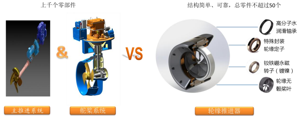
图 12: 全自由度轮缘驱动推进技术可靠、简单
