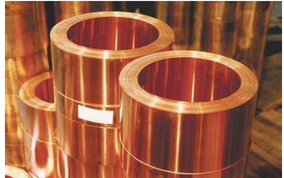
图 21：磷铜：添加磷的铜合金，耐腐蚀
